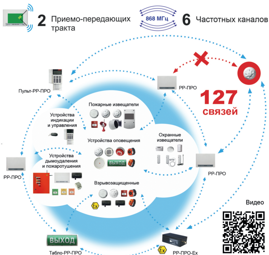
▲ Рис. 1. Резервирование линий связи в "Стрельце-ПРО"
