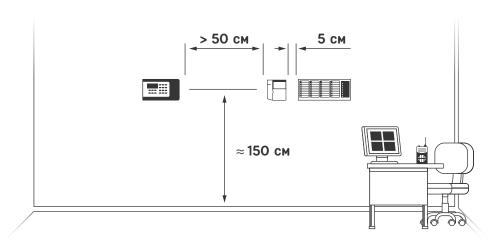
Блок индикации **БУ32-И**, пульты **ПС-И** и **Пульт-РР-ПРО** следует размещать на уровне 1,5 метра от пола, но не выше 1,8 метра.
